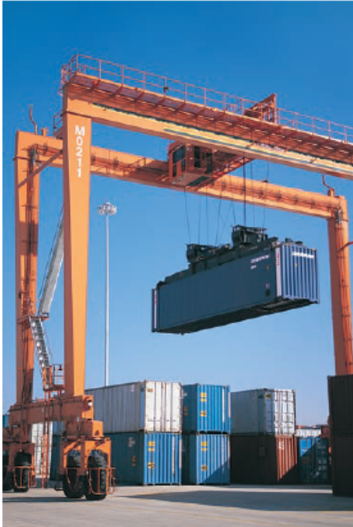
Fotografía 11.2 En esta grúa de embarcadero se utilizan múltiples cables y poleas.
